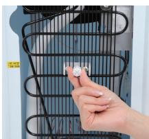
13 ウォーターガードにエアフィルターを取り付けてから本体にセットし、「CLOSE」の位置にスライドさせクリーニングを終了します。
